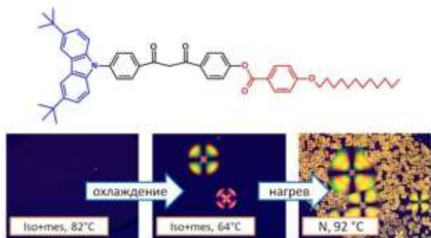
Рисунок 1 – Схематическое изображение и микрофотографии фазовых переходов \beta -дикетона
