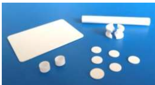
Рисунок 1 – Примеры изделий из керамики на основе оксида алюминия, полученных методом лазерной стереолитографии из керамической пасты разработки НИЦ «Курчатовский институт» - ВИАМ
