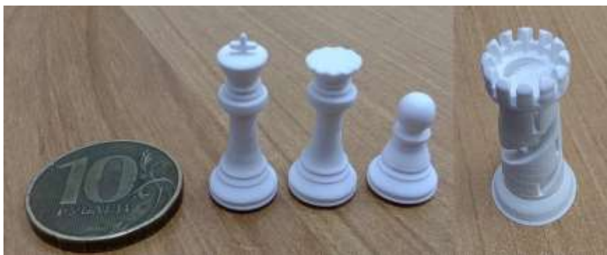
Рисунок 1 – Изделия алюмооксидной керамики, полученные по технологии DLP из низковязкой высоконаполненной керамической суспензии
