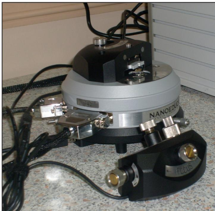
Сканирующий зондовый микроскоп.
